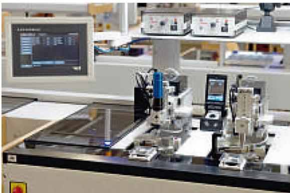
**Mit bis zu sechs verschiedenen Hebwerkzeugen pro Montagetisch kann das Werkstück exakt und schnell für den nächsten Montageschritt positioniert werden.**
