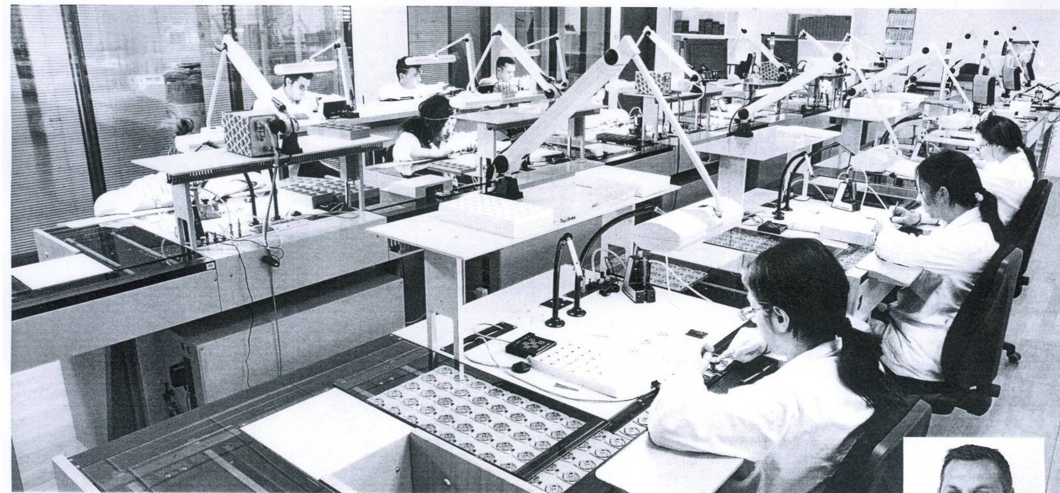
Automatisierte Module und traditionelle Uhrmacher-Arbeitstische: Montagestrasse für Uhrwerke bei der Fossil-Tochter STP in Manno TI.
